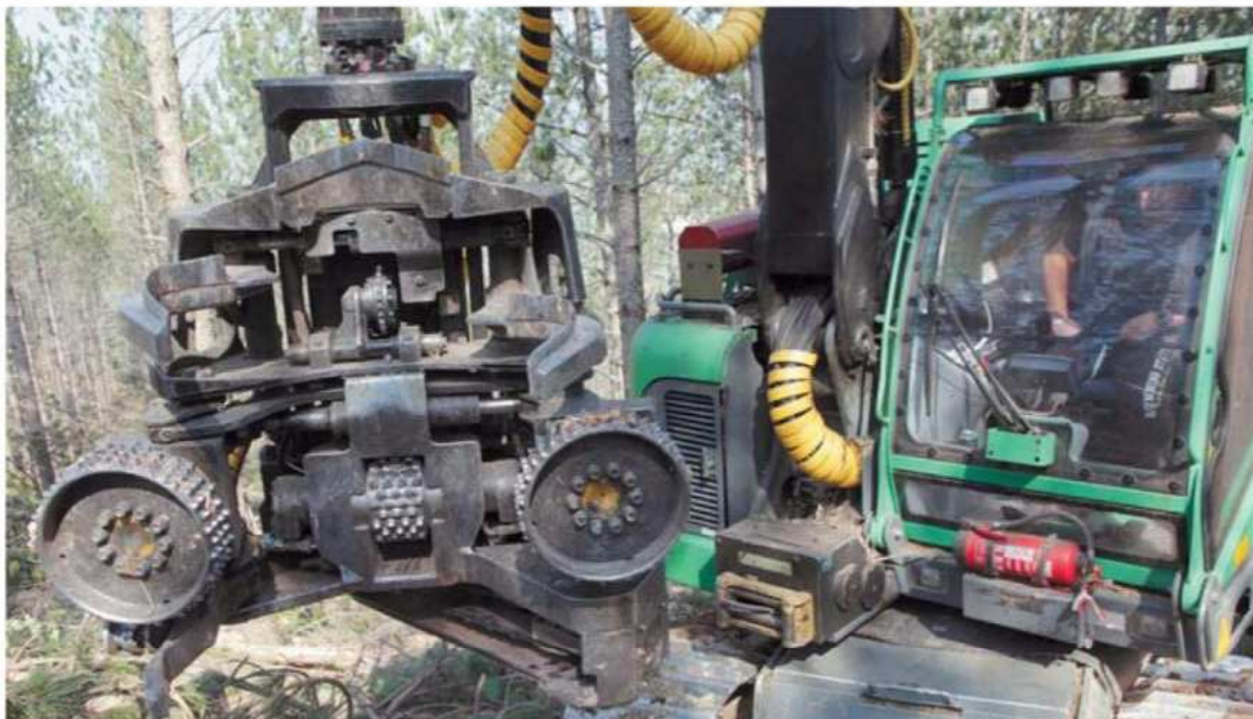
Detalle del engranaje sofisticado que compone el cabezal de la procesadora utilizada para cortar troncos.
